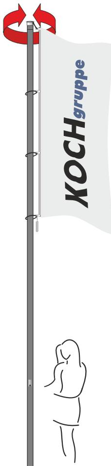
Masten mit innen liegendem Hissseil und Drehkopfsystem sind die komfortabelste Variante Hissflaggen zu präsentieren, der Flaggenwechsel erfolgt in bequemer Stehhöhe.
